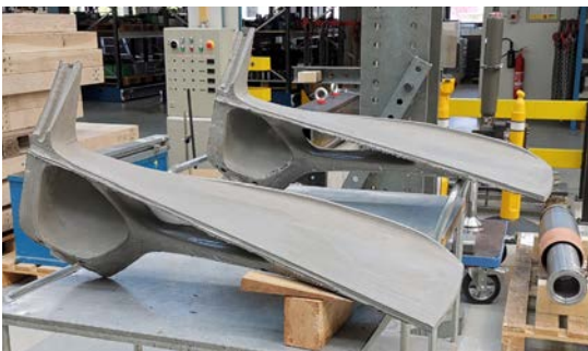
SW Umwelttechnik stellte die UHPC-Stufen auf Basis der 3D-Schalungen in einem eigenen Werk her.
